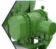
1 Bomba de vacío de 7.5 hp. Edwards STOKES Mos.212
